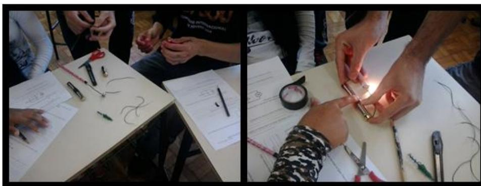
Para o experimento foram necessárias duas pilhas de 1,5V cada, uma lâmpada de 2,5V e fita isolante. No roteiro entregue aos estudantes, havia o esquema do circuito a ser montado de acordo com as representações utilizadas na Física. Uma das tarefas exigia que os estudantes desenhassem o circuito na realidade e identificassem que tipo de ligação (série, paralelo ou mista) estava sendo montado, pois em conteúdos anteriores, como as Leis de Ohm, percebeu-se certa dificuldade em fazer essa distinção.
